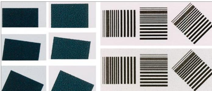
Abbildung 8: Im Inkjet gedruckte Kanten und Linien
