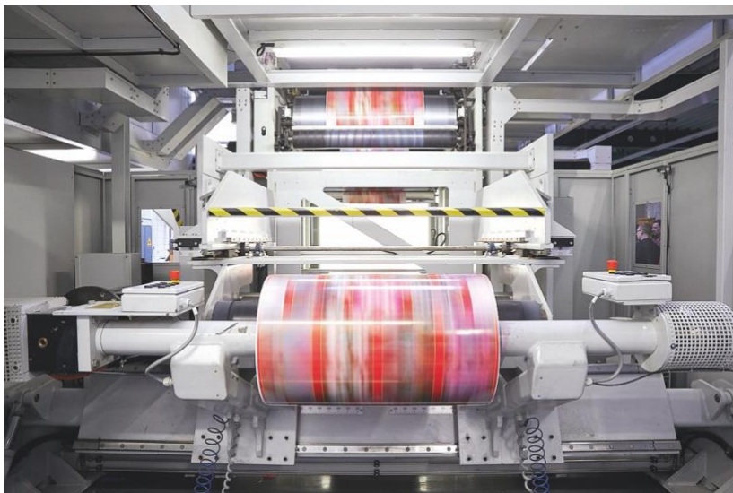
Bildunterschrift: Die 8-Farben Zentralzylinderdruckmaschine vom Typ Bobst Flexpress 6S/8 im Drucksaal des DFTA-TZ
