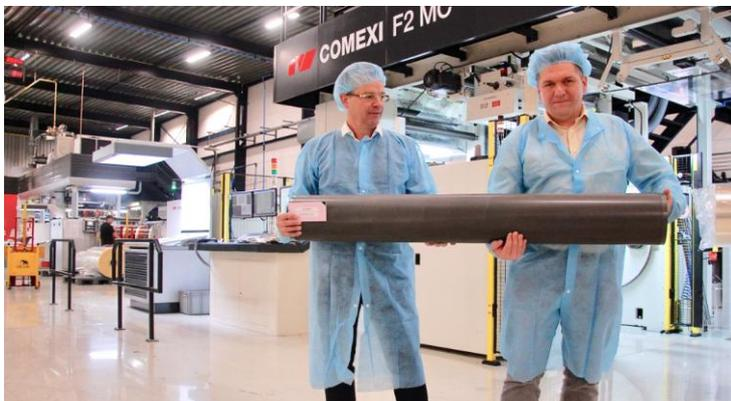
**Bild: Weinand van Kesteren und Jan Bijl (Apex-Kundenbetreuer von VIV) halten eine GTT-Farbdosierwalze – eine der bedeutsamsten Komponenten, um beim Smart Digital Flexo-Konzept die erforderliche Konsistenz zu erzielen**
