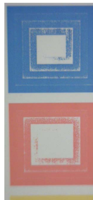
Abb. 3: Gedruckte Ergebnisse eines Testdruckes mit RWBK-Elementen vor der Korrektur der Rasterwalzenbeistellung zur Erzielung gleicher Beistellung bei C und M
