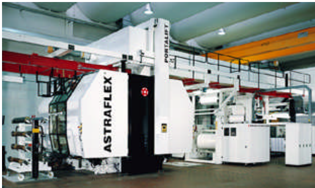
ASTRAFLEX ® : Hochleistungs- Zentralzylindermaschine mit Roboterhandling – natürlich auch zur Sleeveanwendung
