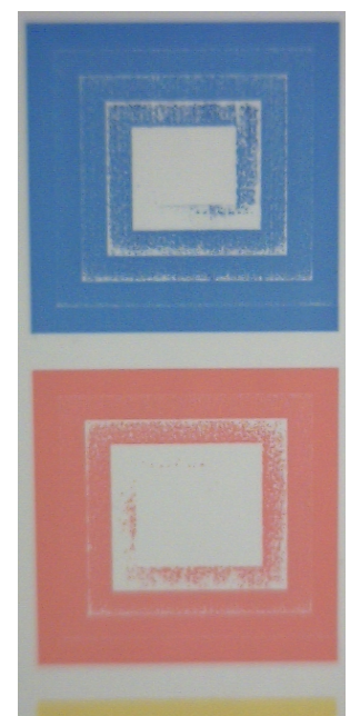
Abb. 3: Gedruckte Ergebnisse eines Testdruckes mit DFTA RWBK-Elementen vor der Korrektur der Rasterwalzenbeistellung zur Erzielung gleicher Beistellung
