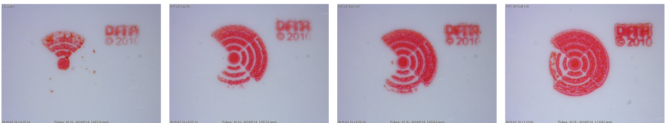
Abb. 2 bis 5, von links: DFTA KE 1.0 bei Kissprint-Einstellung; Normale Druckbeistellungen; erhöhte Druckbeistellung bei normaler Rasterwalzen-Beistellung; erhöhte Beistellungen RW-DF und DF-Bedruckstoff
